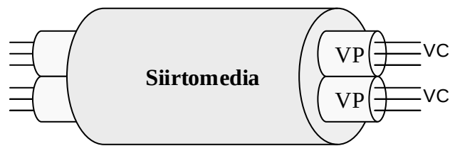
Kuva 3. ATM-yhteyksien kolmiportainen hierarkia.
